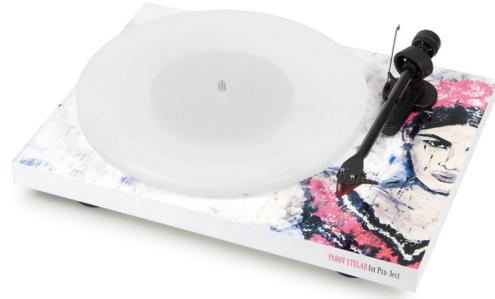
Riemenantrieb nutzt einen ruhig laufenden AC-Motor mit effektiver Entkopplung vom Chassis und TPE-Bedämpfung sowie einen ultrapräzisen AC-Generator (ähnlich Speed Box) für ultimative Drehzahlstabilität und Vibrationsfreiheit. Durch die wirkungsvollen Hightech-Dämpfungsfüße aus TPE (Thermoplastic Elastomere) kann eine um bis zu 20% höhere Lautstärke ohne Rückkopplungsgefahr erzielt werden.
